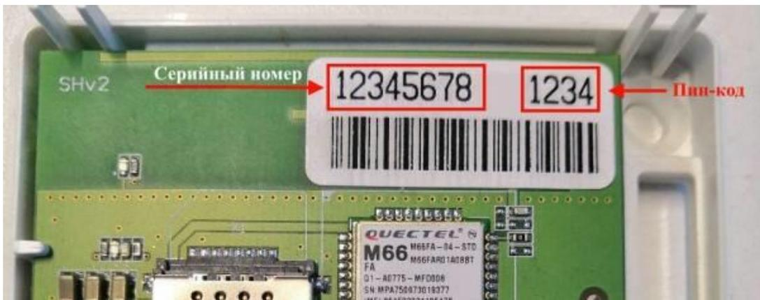
Complete: dirección del dispositivo - número de serie del dispositivo, código PIN - últimos 4 dígitos en el código de barras del dispositivo. Y seleccione el clúster ("Security Hub o Astra Pro 4.0"). Haga clic en el botón "Agregar".
